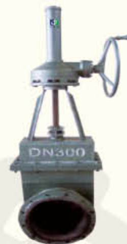
蜗轮传动双面 密封衬胶闸板阀
