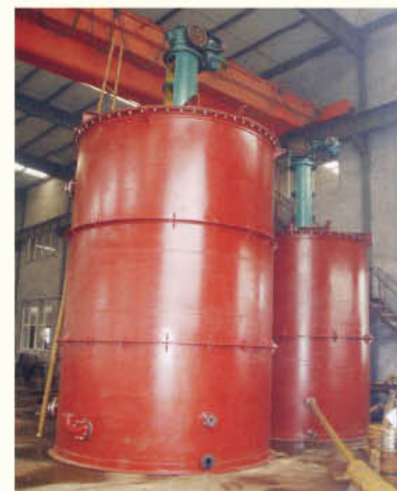
多晶硅装置污水处理搅拌设备
