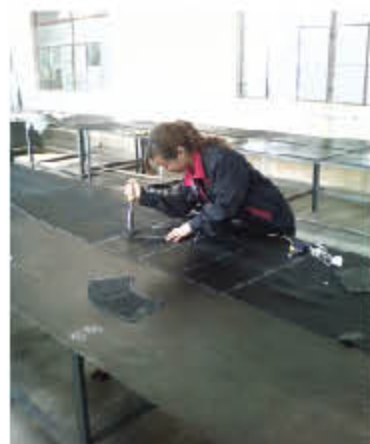
将胶板裁剪成与钢件表面吻合的形状
