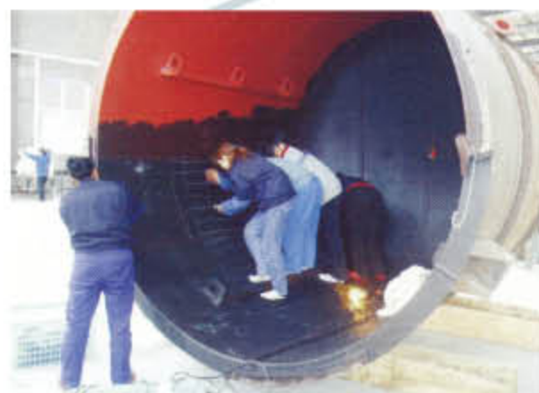
将裁剪好的胶板按预定计划贴在钢件表面
