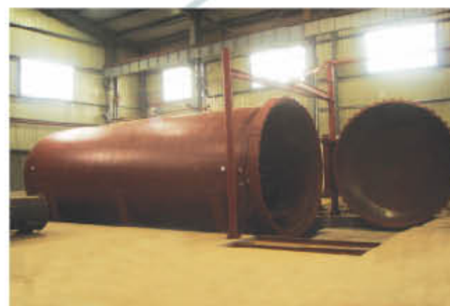
按胶种的不同选择正确的硫化工艺进行加压硫化
